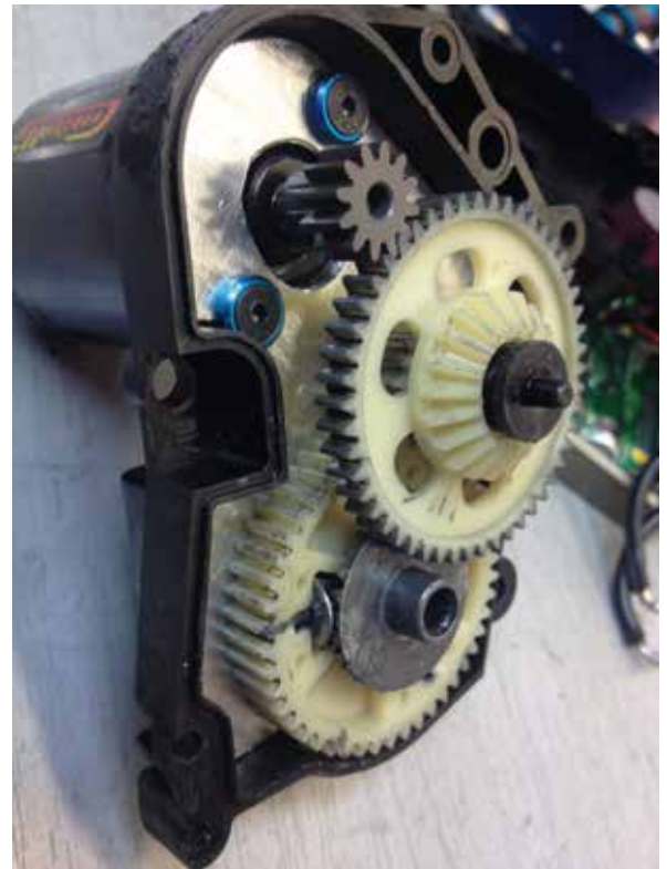
Dreven i växelhuset. Plattan i aluminium har Svein Harald sågat till för att han ska kunna finjustera drevspelet och kunna köra med mindre pinjonger.
